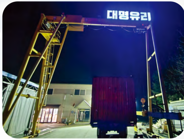
Gantry & Container Trailer Truck 크레인용 유리판재 하역장치 특허 제10-2064382호
