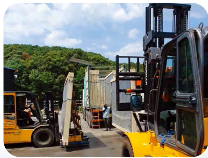
Flat Glass Loading & Unloading 지게차용 유리판재 적재장치 특허 제10-2003398호
