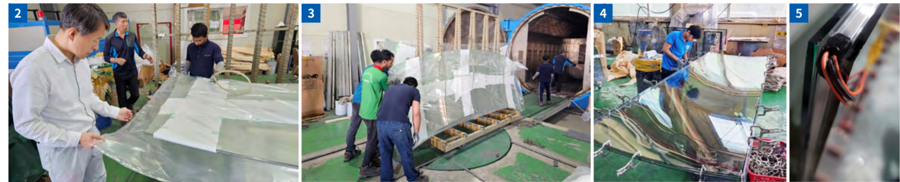
사진2 : 곡접합유리는 예압이 불가능해 Free Pressing Bag Packing을 통한 음압 작업이 필수적이다. 우신복층유리 정보 곡접합유리 작업 현장에서 Bag 누기여부를 점검하고 있다. 사진3 : 정보 곡접합유리를 본압(오토크레이브) 공정에 투입하고 있다. 사진4,5 : 곡복층유리 2차 실링 작업 및 PDLC/BIPV 등 각종 전기선 투입유리의 코너기를 활용한 전선 배출작업(곡복층유리는 곡강화 이후 모든 단계에 수작업으로 프레스싱, 알곤 가스주입 및 2차 실링을 모두 수작업을 수행한다. 또 복층유리 내부 전기선을 외부로 배출해야 하는 복층유리의 전기선 Drain-Out을 위한 코너기 특수 가공 및 마무리 작업도 필요하다)
